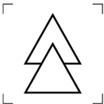
Рисунок 3 - Работа под напряжением (двойной треугольник)
