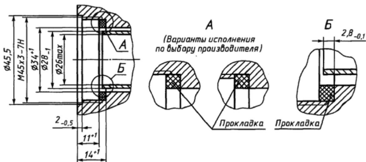
Рисунок Б.4 - Резьбовое соединение с внутренней резьбой для систем с двумя каналами подачи воздуха PIB
