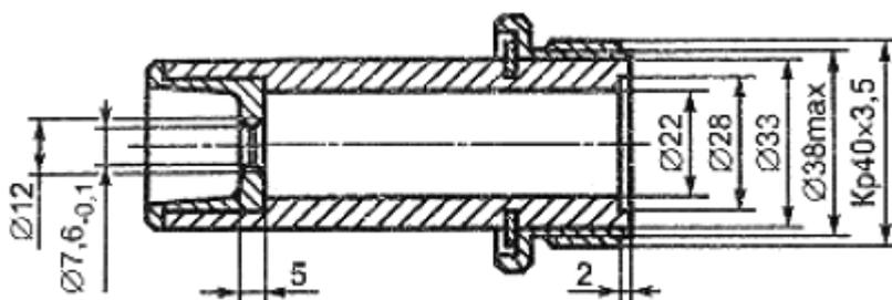
Рисунок 9 - Имитатор фильтра для фильтров/масок на резьбовом соединении
