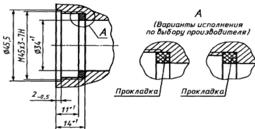
Рисунок Б.3 - Резьбовое соединение с внутренней резьбой для систем с одним каналом подачи воздуха PIA
