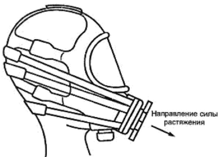
Рисунок 5 - Устройство для испытания соединительного элемента
