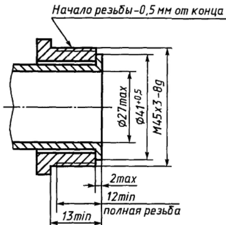
Рисунок Б.1 - Резьбовые соединения с внешней резьбой для систем с одним каналом подачи воздуха PAA
