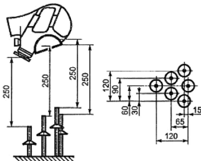
Рисунок 2 - Схема установки, состоящей из шести пропановых горелок
