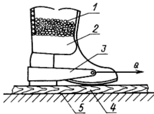
1 - рассредоточенный груз; 2 - образец; 3 - скоба, соединенная с тягой разрывной машины;
