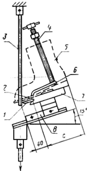
1 - ограничитель; 2 - установочная прорезь; 3 - изгибающая скоба; 4 - установочный винт;
