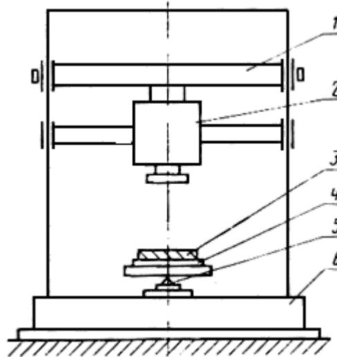
1 - каретка; 2 - боек; 3 - защитный элемент; 4 - плита; 5 - датчик; 6 - основание
